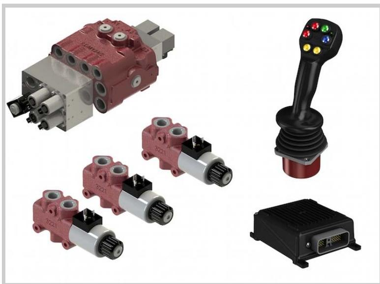
Cinque i componenti principali: un distributore proporzionale, sia a centro aperto sia Load Sensing, SDM127/DLM127 a due sezioni con valvola elettrica di sicurezza, low leak valve per riduzione trafile e controllo discesa, sensori di posizione sui cursori SPSL, una centralina CAN CED252, un joystick CAN CJW con segnali di ridondanza ibridi.
