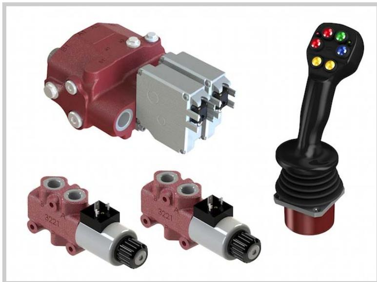
Due i componenti principali: un distributore proporzionale sia a centro aperto sia Load sensing SDM122/DLM122 a due sezioni con moduli meccatronici MCS di nuova generazione, comandato da un joystick CAN CJW. Il joystick può comandare deviatori di flusso per il controllo delle funzioni ausiliarie.
