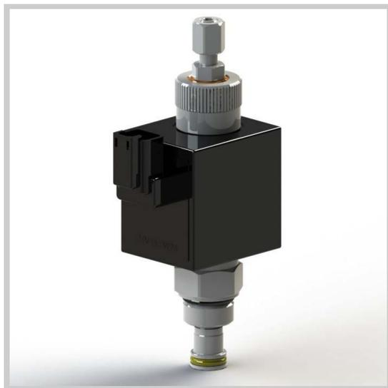
La valvola è ad azionamento diretto con trafileamento di 0.3cc/min (5gocce/min), portata sino a 10 l/min con ridotte perdite di carico (<15 bar@10 l/min). Queste caratteristiche consentono di aumentare la produttività e di mantenere inalterata la densità della rotoballa anche quando la macchina non sta raccogliendo fieno.
