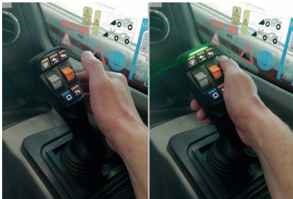
Joystick Walvoil DJW per Isobus e sistemi di sicurezza con impugnatura MTH operatore presente capacitivo (dead man).
