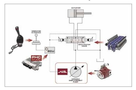
LA PARTICOLARITÀ DELLA CONFIGURAZIONE ALS – FLOW CONTROL È LA COMBINAZIONE DI UN NORMALE DISTRIBUTORE A CENTRO APERTO A COMANDO ELETTROPROPORZIONALE CON LA POMPA A CILINDRATA VARIABILE A CONTROLLO ELETTRONICO E DOTATA DI LOGICA ALS
