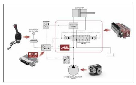
LA SOLUZIONE ALS – LS ELECTRONIC CONTROL CONSENTE LA REALIZZAZIONE DI FUNZIONI PRESSURE CONTROL IN ABBINAMENTO A DISTRIBUTORI FLOW SHARING DELLE SERIE DPX ED EPX
