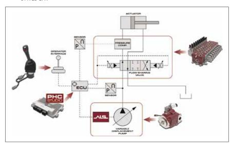
IN CASO DI UTILIZZO DI POMPE A CILINDRATA VARIABILE IL SISTEMA ALS AMPLIA LE PROPRIE CAPACITÀ DI RISPARMIO E DI CONTROLLABILITÀ GRAZIE ALLA GESTIONE DEL CONTROLLO ELETTRONICO DELLA POMPA STESSA
