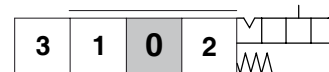
Tipo F005A Con molla A, ritenuta in 4ª pos. Per sezione flottante
